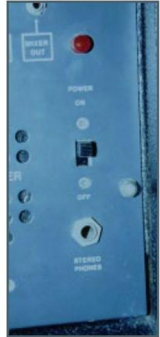
**Figura 1-3:** Toma de auriculares, interruptor de encendido y luz indicadora del ARP 2600.
