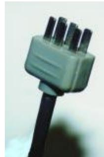
Figura 1-2: Cable de conexión del teclado con múltiples patillas.
